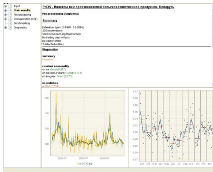
Рис. 5.15. Экран с результатами расчетов алгоритмом RSA5c семейства X-11. Индекс цен производителей сельскохозяйственной продукции, страна 1.
