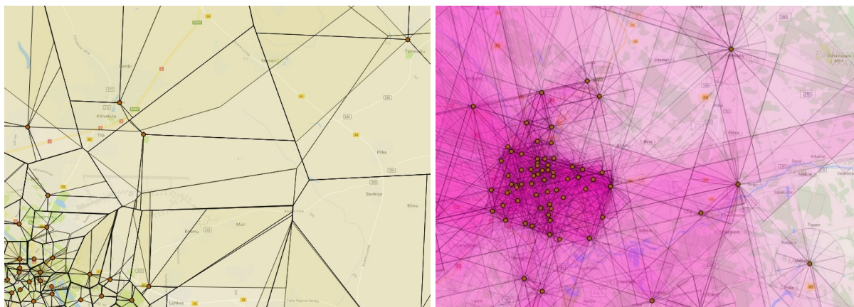
Рисунок 2.5 Пример двух разных методов для расчета теоретической зоны покрытия антенны в сети: а) полигоны Вороного/Тиссена; б) теоретические секторы зоны покрытия
