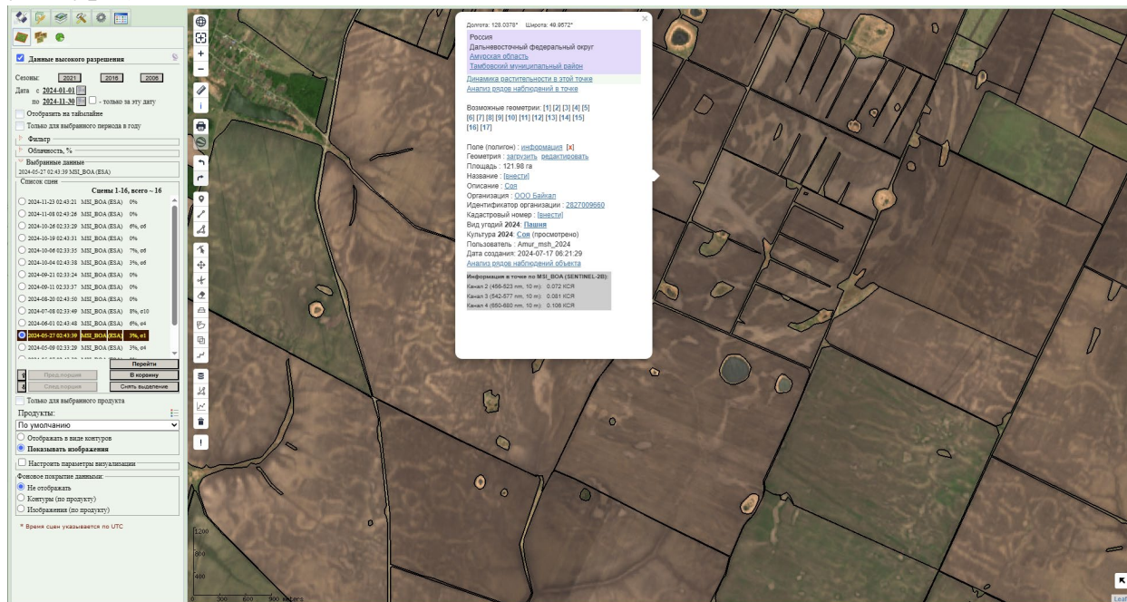
Рисунок Г.4.4 - Пример отображения в картографическом интерфейсе ТКД СХМП векторных границ полей и атрибутивной информации
