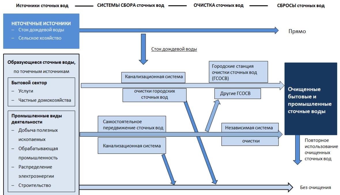
Рисунок 1: Схематическое изображение источников сточных вод, систем сбора и очистки (изменено по сравнению с диаграммой загрузки сточных вод, ОЭСР/Евростат 2018).
